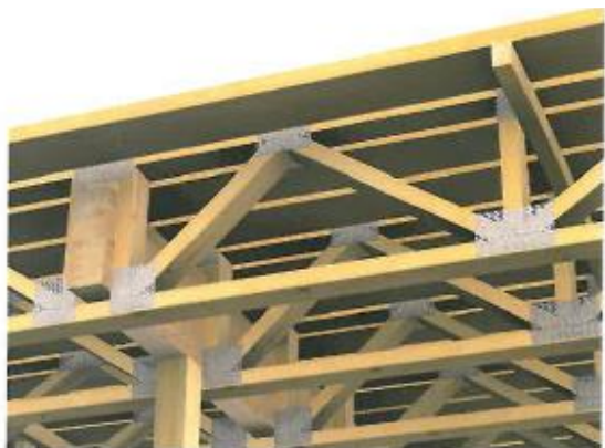
Fig 6. Gitterbjelkelag med tverrgående bærebjelke understøttet av søyle
