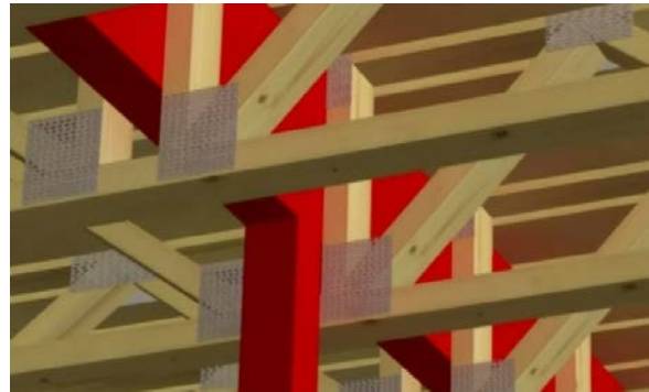
Dersom innvendig bæring er nødvendig, kan denne legges skjult inne i konstruksjonen.
