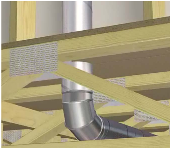
Rørføring fra dekke og opp i delevegg....
